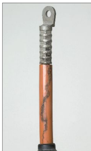
Образец, поврежденный трекинговой дорожкой
